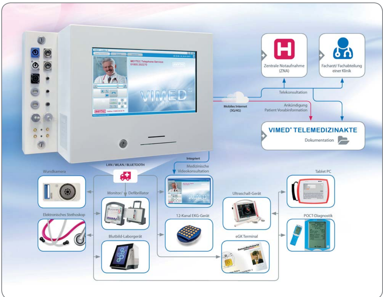
Abb. 6: VIMED® CAR 3 Funktionsprinzip (Quelle: MEYTEC 3 )
